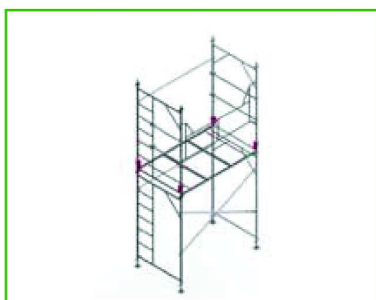
MONTAGEM COM ELEMENTO HORIZONTAL
