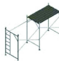
Montando o elemento horizontal
