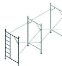
Ampliando a montagem
